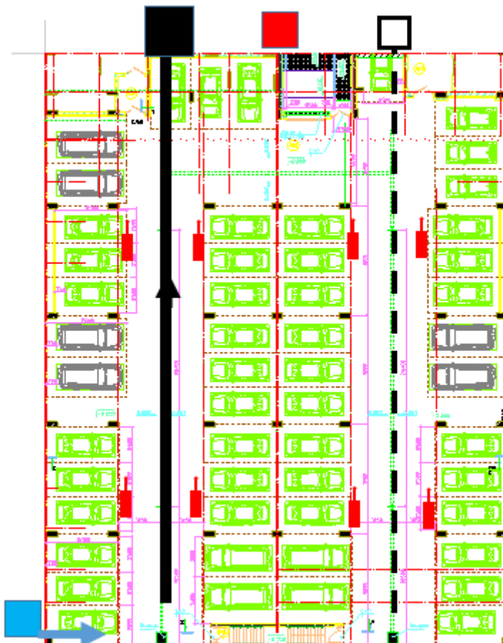
Рис. 3. Комбинированная схема вентиляции автостоянки площадью 4 000 м 2
