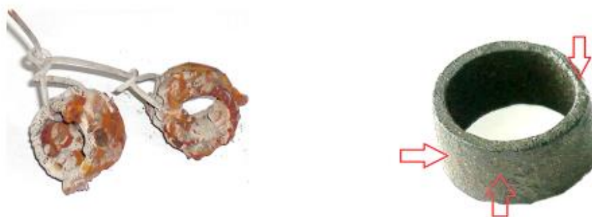
Вид образцов для замера скорости коррозии до обработки ( V_{\text{кор}} = 0,655 мм/год) и после ЭМВ ( V_{\text{кор}} = 0,227 мм/год)
