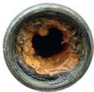
а) Напорная канализация
