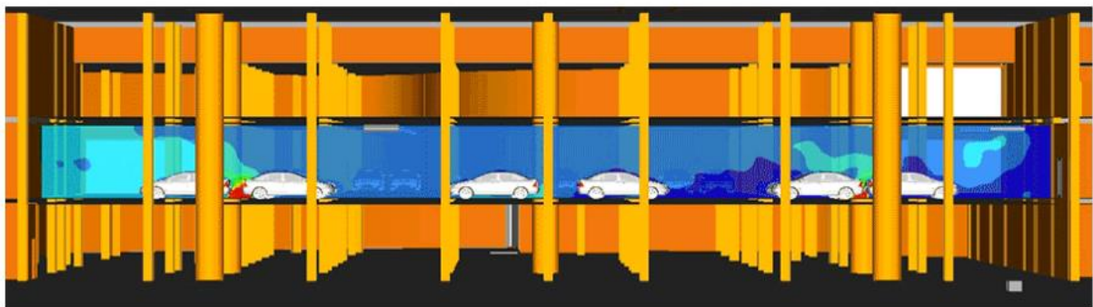
Рис. 5. CFD-моделирование поля концентрации CO в помещении автостоянки, оснащенной струйной вентиляцией
