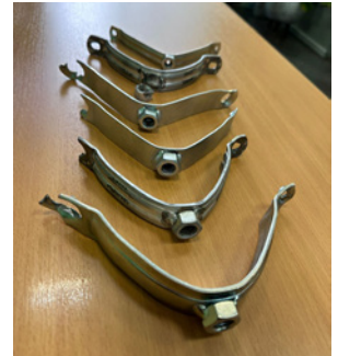
Трубные хомуты разных брендов после испытаний
