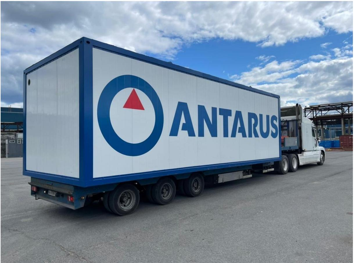
ANTARUS в блок-боксе — это разборная конструкция. При размещении крупного оборудования внутри станции блок-бокс можно составить из неограниченного количества модулей, каждый из которых соответствует габаритам платформ и тралов, предназначенных для транспортировки к месту строительства.
