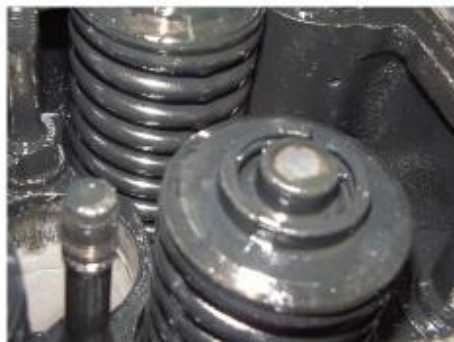
Рис. 10. Состояние системы газораспределителя до и через год после ЭМВ.
