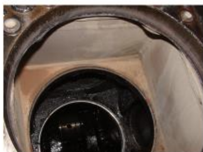
Рис. 11. Состояние рубашек охлаждения до и через год после обработки
