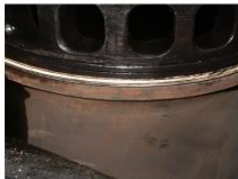
Рис. 9. Состояние втулок цилиндров до и через год после ЭМВ
