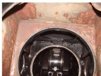
Рис. 11. Состояние рубашек охлаждения до и через год после обработки
