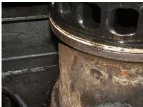
Рис. 9. Состояние втулок цилиндров до и через год после ЭМВ
