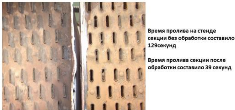
Рис. 12. Состояние секций холодильника до и через год после ЭМВ
