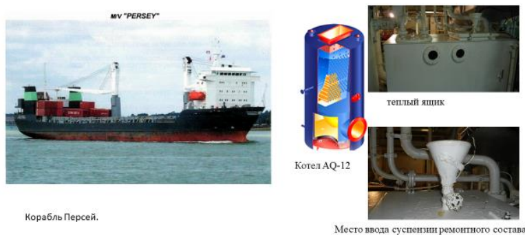
Рис. 16. Обработка ЭМВ водяного тракта котельной корабля «Персей». Обработка водяного тракта и проведение очистки системы от накипно-коррозионных отложений проводилась в период навигации судна
