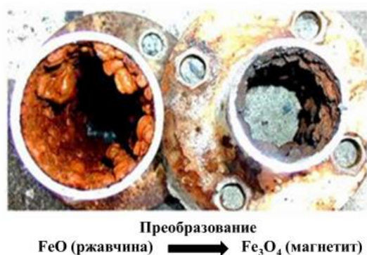
Рис. 21. Преобразования ржавчины в магнетит при использовании электронных импульсов (установка Vulkan Германия)
