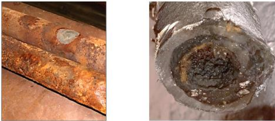
Рис. 6. Состояние сетей ГВС транспортного комплекса. Коррозионные повреждения с наружной стороны, подварки, забитое сечение коррозионно-накипными отложениями
