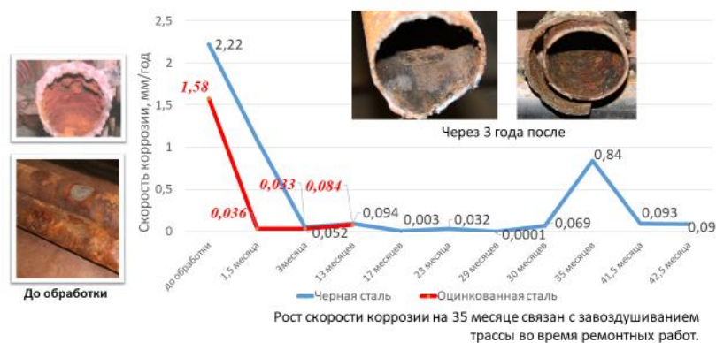
Рис. 17. Динамика изменения скорости коррозии и общий вид элементов системы ГВС Рижского вокзала до и после ЭМВ
