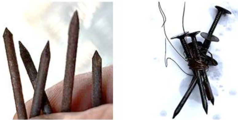
Рис. 14. Внешний вид образцов для замера скорости коррозии в системах паровых котлов BOOSTER
