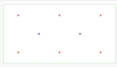
Рис. 4. Установка извещателей с учетом алгоритма принятия решения о пожаре и параметра «Адресность»
