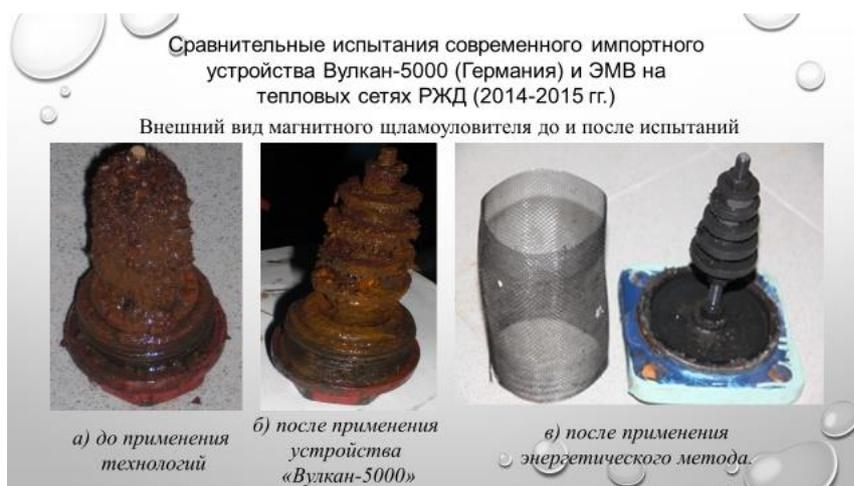
Рис. 20. Сравнительные испытания современного импортного устройства «Вулкан 500» (Германия) и ЭМВ на тепловых сетях ОАО «РЖД» (2014–2015 гг.)
