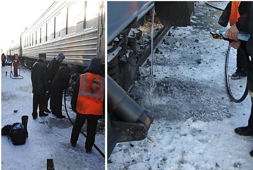
*Рис. 4. Поточная обработка систем водотеплоснабжения пассажирских вагонов в эксплуатационном депо*
