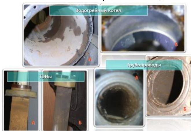
*Рис. 12. Внешний вид котлов, ТЭНов, трубопроводов отопления до и после ЭМВ*
