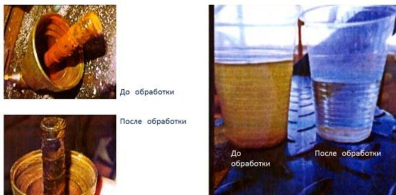
Рис. 18. Состояние оборудования и воды до и после ЭМВ
