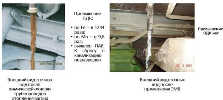
Рис. 3. Внешний вид сточных вод из трубопроводов пассажирского вагона при использовании химочистки и ЭМВ
