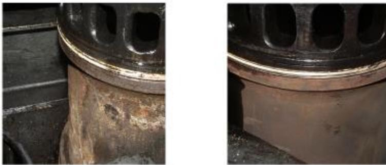
*Рис. 5. Состояние втулок цилиндров тепловоза 2М62У № 0083 до и после обработки ЭМВ и года эксплуатации*
