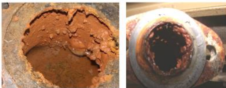
Рис. 9. Микробиологическая коррозия на сетях заправки вагонов водой и водопроводе пассажирского вагона
