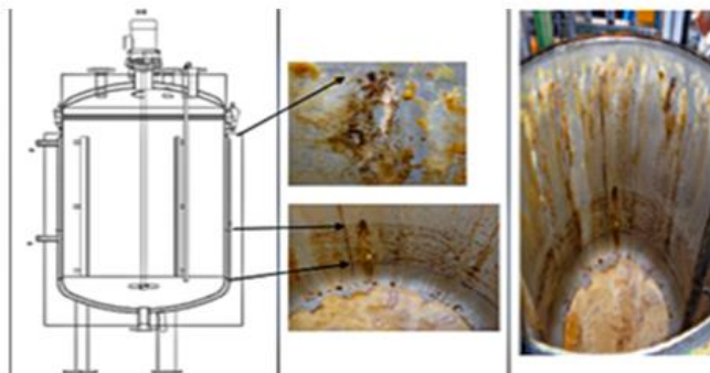
Рис. 11. Коррозионные разрушения систем водоохлаждения импортного оборудования (Германия), выполненного из нержавеющей стали, из-за употребления воды низкого качества (псевдоустойчивой)
