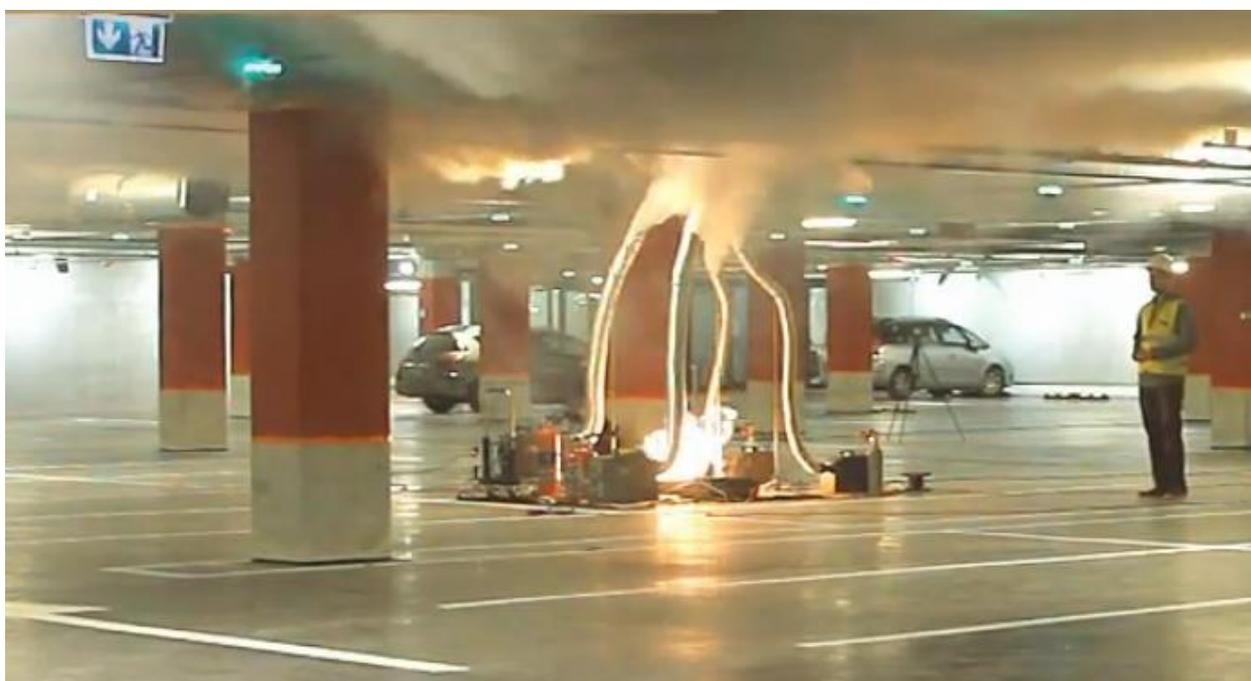
*Рис. 1. Дымовой слой в подпотолочном пространстве*
