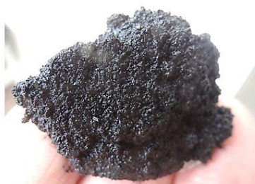
Рис. 11. Вид продуктов жизнедеятельности продуцирующих в трубопроводе железовосстанавливающих бактерий
