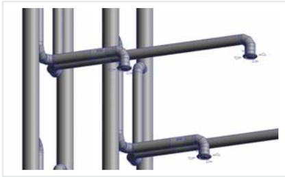
*Узел подключения поэтажного отвода вытяжной системы через воздушный затвор*
