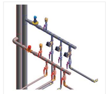
*Узел подключения поэтажного коллектора системы отопления*
