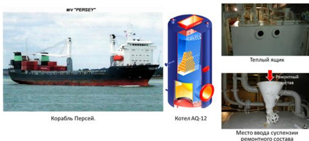
Рис. 4. Обработка ЭМВ водяного тракта котельной корабля «Персей» № 821439 (26.05.2014)
