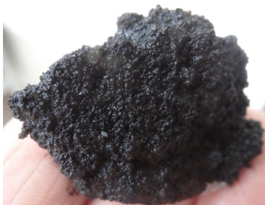
Рис. 2. Биообрастание трубопроводов из металлопласта (покрытие полипропилен) при использовании низкозамерзающей жидкости
