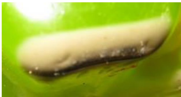
Рис. 2. Биообрастание трубопроводов из металлопласта (покрытие полипропилен) при использовании низкозамерзающей жидкости
