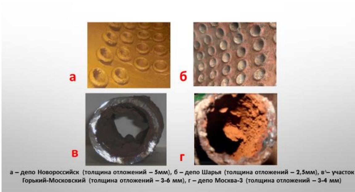
Рис. 5. Состояние внутренних поверхностей барабанов котлов и трубопроводов до ЭМВ
