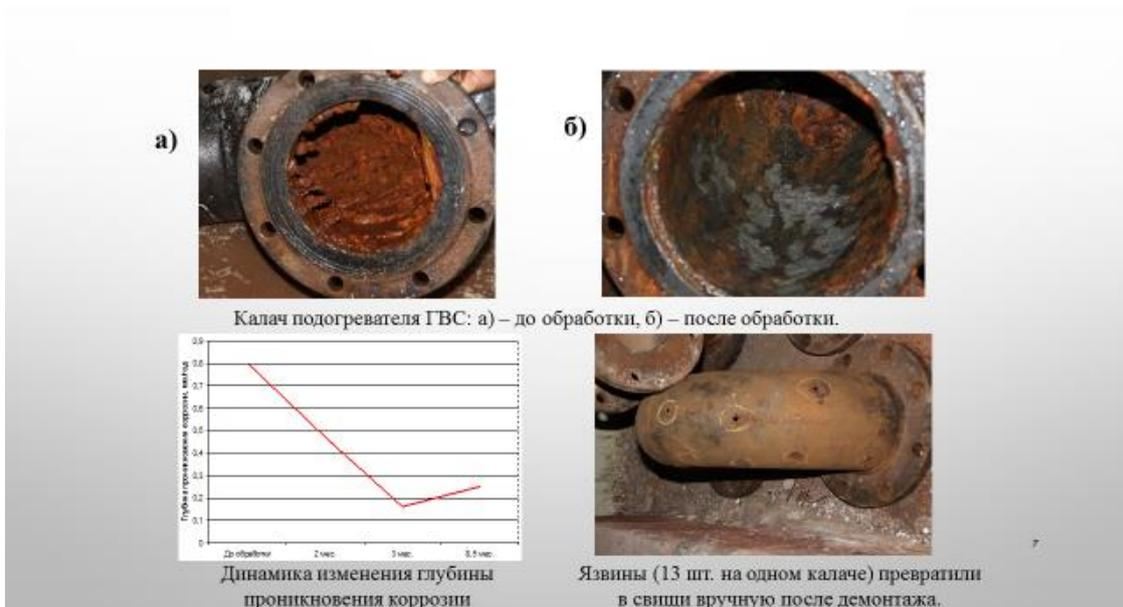
Рис. 6. Возможность использования энергетического метода для обработки изношенных тепловых сетей
