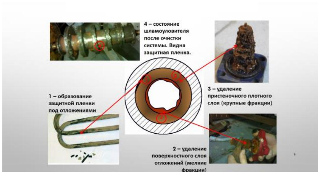
Рис. 8. Этапность технологического процесса обработки системы с толщиной отложений более 3 мм энергетическим методом
