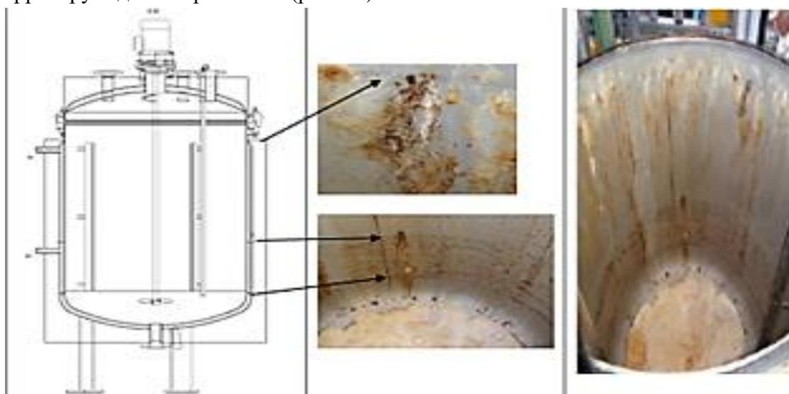
*Рис. 11. Коррозионные разрушения системы водоохлаждения импортного оборудования (Германия), выполненного из нержавеющей стали, из-за употребления воды низкого качества (псевдоустойчивой)*
