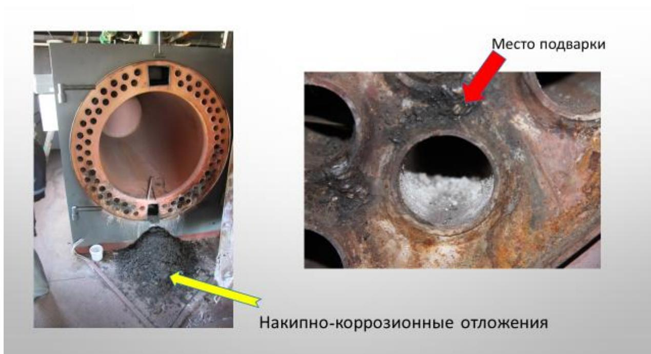
Рис. 20. Состояние импортного котла при недостаточной водоподготовке
