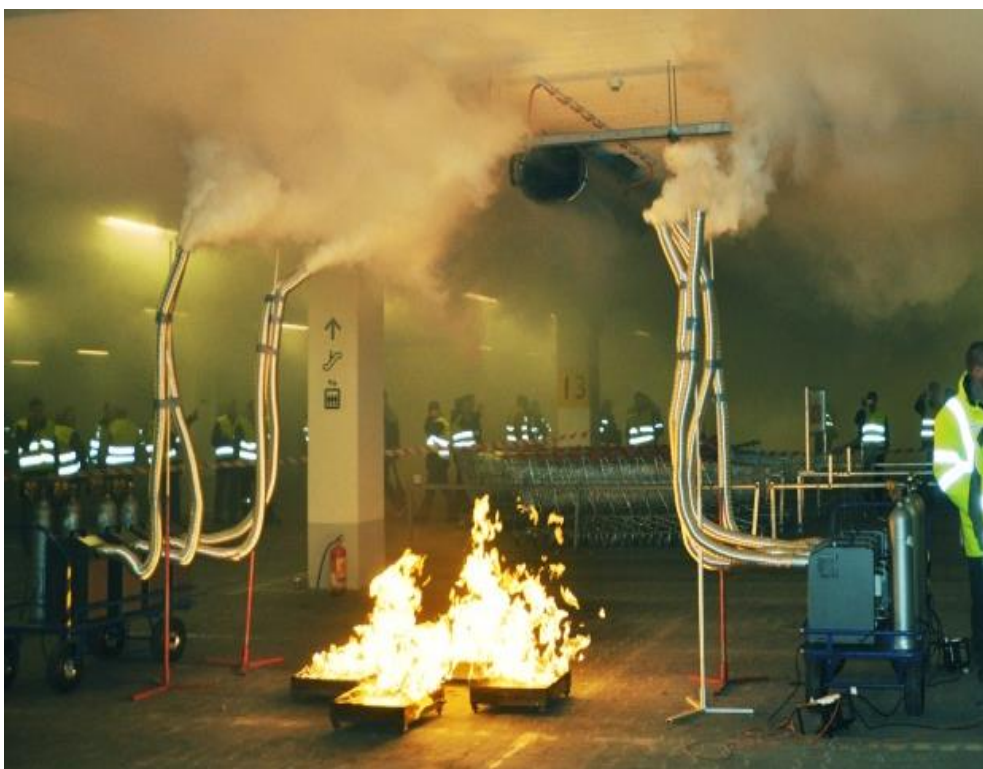
Рис. 5. Испытание противодымной вентиляции с использованием горячего дыма
