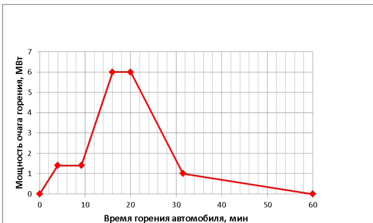
Рис. 4. График временной зависимости мощности очага горения при пожаре одного автомобиля
